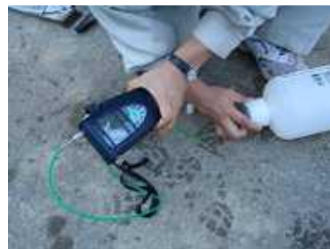
可燃性ガス濃度測定（現地調査）
