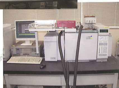
GC-MS （エチルベンゼン等 有機溶剤の測定）
