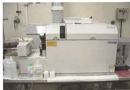
ICP-MS （インジウム、 コバルト等 金属の測定）
