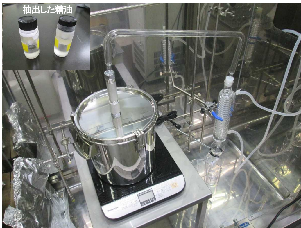
アロマオイル試験蒸留装置
