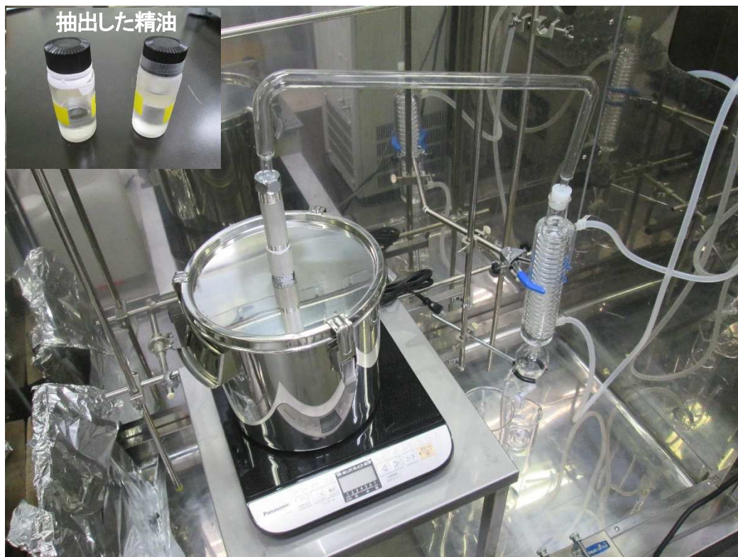
アロマオイル試験蒸留装置
